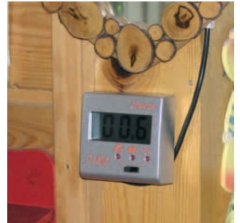
... ja "tuvan puolella" näyttö, josta ilmenevät latausvirta, akun jännite ja kulutusvirta.
